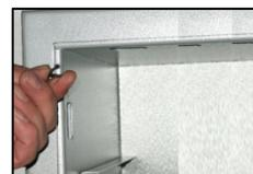
**Zum Schmieren der Türbänder** etwas Öl in den Spalt zwischen Ober- und Unterteil einbringen (Bilder 8 - 11) und ggf. das übergelaufene Öl abwischen. Zum Schmieren sind alle handelsüblichen Schmieröle geeignet. Wie oft geschmiert werden muss, richtet sich nach der Nutzungshäufigkeit, mindestens jedoch einmal jährlich.
